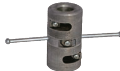
Freza din metal pentru polipropilena
